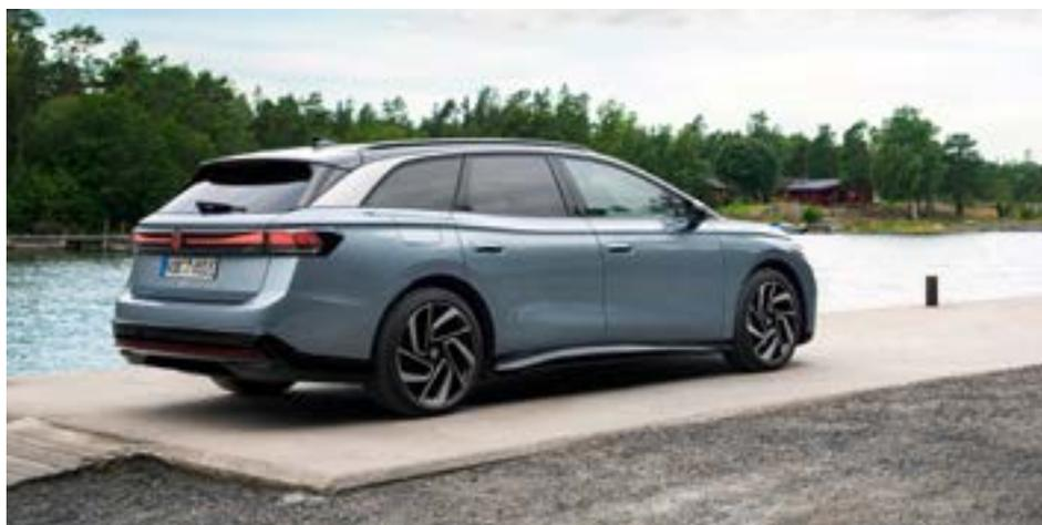
— Elegante e simultaneamente muito discreta na condição de 100% elétrica, a carrinha VW ID.7 tem quase cinco metros de comprimento e um coeficiente de arrasto baixo, de apenas 0,23 Cx, porém decisivo para mover as quase 2,2 toneladas com maior eficiência de consumo. A carrinha elétrica equivalente em termos de dimensões é a A6 Avant e-tron, mas concorre num patamar de preço mais elevado.
